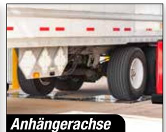
Hunters berührungslose HD-Inspektionslösung liefert Gesamtpur-, Lenkroll- und Profiltiefen-Daten in wenigen Sekunden, auch bei Konfigurationen mit mehreren Anhängern und Super-Single-Reifen.
